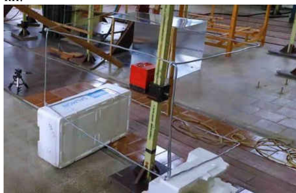
Рис. 10. Пассивный контурный экран макета экспериментальной установки. 10
