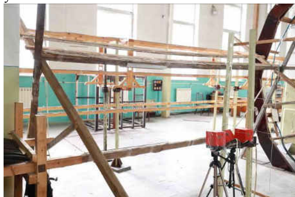
Рис. 9. Две компенсирующие обмотки активного экрана макета экспериментальной установки. 9
