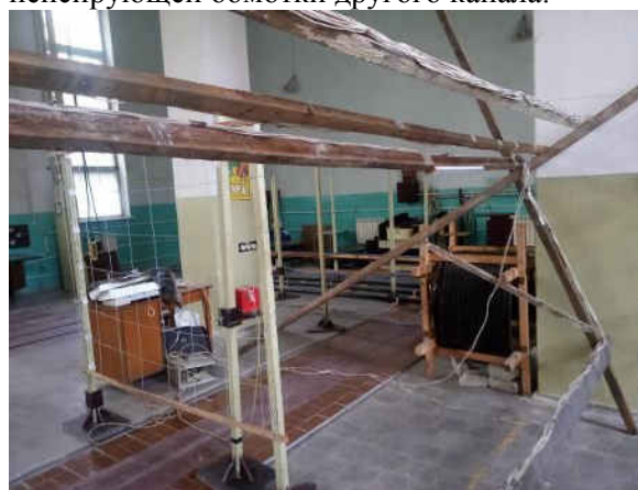
Рис.10. Две компенсационные обмотки модели двухконтурной системы активного экранирования. 10
