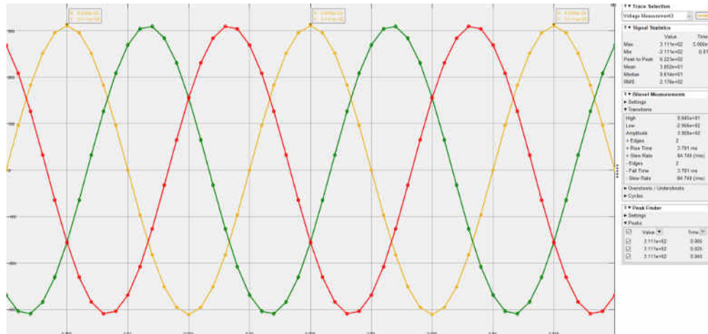
Fig.3.22. Curba tensiunilor de linie din nodul 11 a circuitului trifazat cu SGD U=380\text{ V} (faza C U_C=0\text{ V} ) pentru P=5,6\text{ kW}
