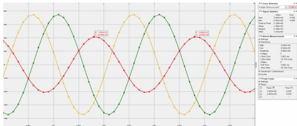
Fig.3.23. Curba tensiunilor de linie din nodul 11 a circuitului trifazat nesimetric cu SGD conectate și cu firul nul deconectat U=380\text{ V} (faza C) pentru P=5,6\text{ kW}
