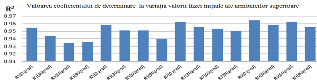
Fig. 3.25. Diagrama variației coeficientul de determinare R^2 în funcție de numărul armonicilor luate în calcul
